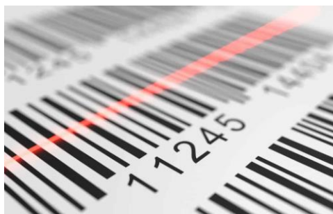
Рис. 104. Процесс сканирования одномерным сканером штрих-кодов
