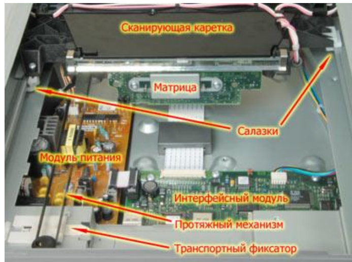
Рис. 74. Расположение основных функциональных узлов сканера
