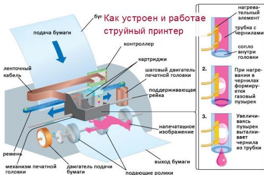
Рис. 18. Схема устройства термоструйного принтера
