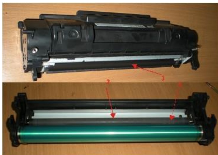
Рис. 28. Картридж лазерного принтера в разобранном состоянии
