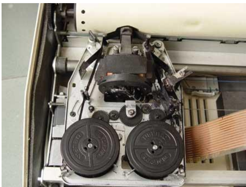
Рис. 4. Механизм протяжки красящей ленты с печатающей головкой Robotron CM 6329.02 M
