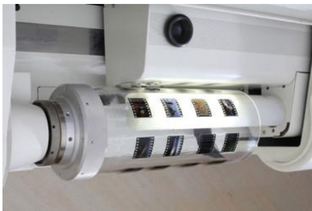
Рис. 85. Размещение отдельных кадров рулонной пленки на барабане
