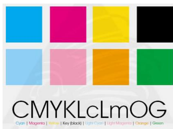
Рис. 22. Цветовая схема для струйных принтеров СМУКLCmOG
