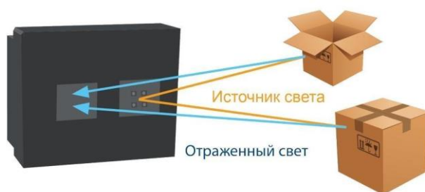
Рис. 97. Принцип действия времяпролетного 3D-сканера
