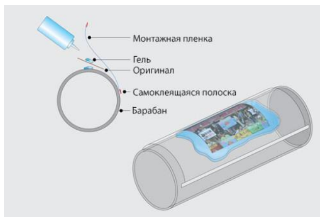
Рис. 86. Использование геля может компенсировать царапины на несущем слое, а также предотвратить появление колец Ньютона
